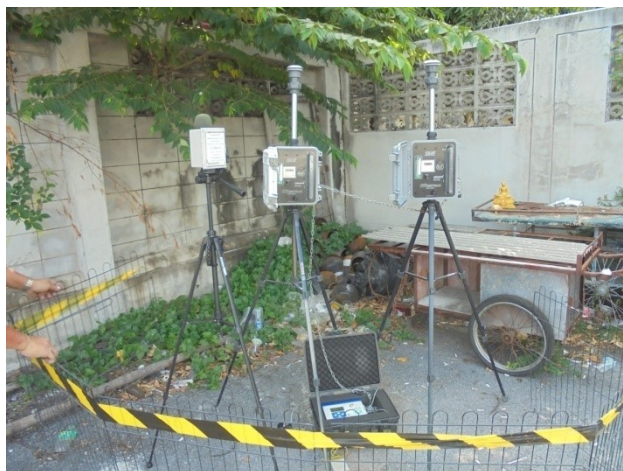
ติดตั้งเครื่องตรวจวัดฝุ่นละออง แบบ Gravimetric method , เครื่องตรวจวัดระดับเสียง Integrating Sound Level meter และเครื่องตรวจวัดแรงสั่นสะเทือน บริเวณวัดลานบุญ
