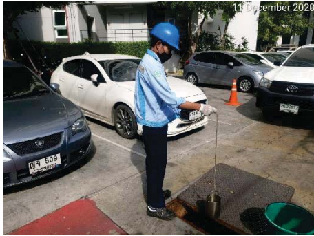
น้ำก่อนเข้าระบบบำบัดน้ำเสีย ชุดที่ 2
