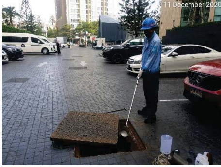
น้ำก่อนเข้าระบบบำบัดน้ำเสีย ชุดที่ 1
