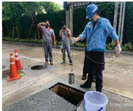
น้ำหลังผ่านระบบบำบัดน้ำเสีย ชุดที่ 2
