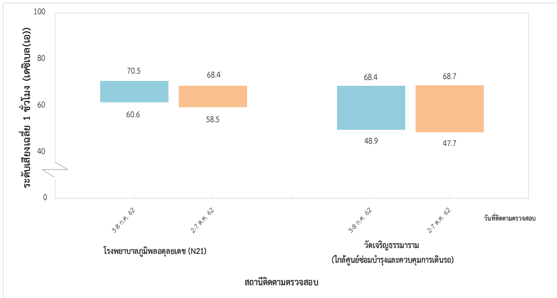
รูปที่ 5-5 ผลการติดตามตรวจสอบระดับเสียงเฉลี่ย 1 ชั่วโมง (L Aeq1 hours) ระหว่างเดือนกรกฎาคม-ตุลาคม พ.ศ. 2562
