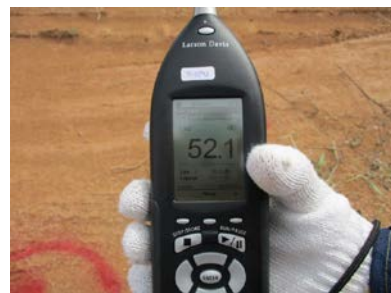
ภาพที่ 2-11 การตรวจวัดเสียงจากแหล่งกำเนิดขณะที่มีกิจกรรมก่อสร้าง
